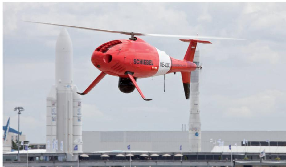
Die unbemannten Helikopter von Schiebel benötigen weder eine Start- noch Landebahn. Sie können sich stationär im Luftraum aufhalten und auch bei starkem Wind sicher landen.
